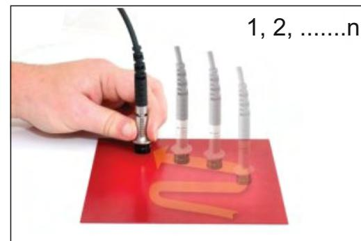
Opmerking: In 'Scanmodus met vasthoudfunctie' kunt u de sonde maximaal 1,5 seconden van het oppervlak afhalen en herplaatsen zonder dat er een nieuwe set metingen wordt gestart. Hierdoor kunt u gaatjes, lasnaden enz. in het substraat ontwijken zonder de meetresultaten te beïnvloeden.
