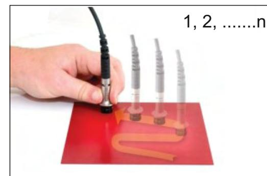
Hinweis: Bei Verwendung des "Scanmodus mit Haltefunktion" kann die Sonde bis zu 1,5 Sekunden lang von der Fläche abgehoben und erneut aufgesetzt werden, ohne einen neuen Satz von Messwerten anzufangen. Dies ermöglicht dem Anwender das Vermeiden von Löchern, Schweißnähten usw. im Substrat, ohne die Messergebnisse zu beeinträchtigen.
