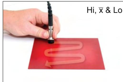
**自动重复模式：**当选定自动重复模式，探头放置在表面上直至移开之前，仪器会以每分钟140读数的速度获取厚度值。每个读数均被存入内存。自动重复模式可大大加快I型钢条，大容器，船坞内的测厚速度。
