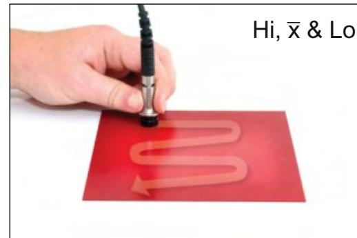
**Mode Auto Repeat :** lorsque ce mode est sélectionné et que la sonde est placée sur le substrat revêtu, la jauge prend automatiquement des mesures à une cadence de 140 par minute, jusqu'à ce que l'utilisateur retire la sonde de la surface. Chaque mesure prise est stockée dans la mémoire de l'instrument. Ce mode permet d'accélérer sensiblement le travail d'inspection sur de larges surfaces telles que poutrelles en I (RSJ's), citernes, coques de navires, etc.
