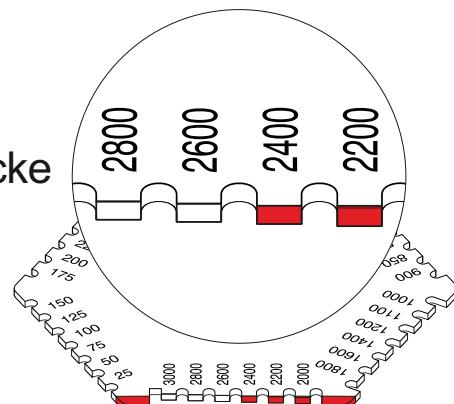
Stellen Sie bei der Verwendung des Kamms an Rohrleitungen sicher, dass er parallel zur Längsachse der Rohrleitung liegt.
