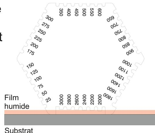
Dans l'exemple illustré, l'épaisseur de film humide se situe entre 2400 µm et 2600 µm.
