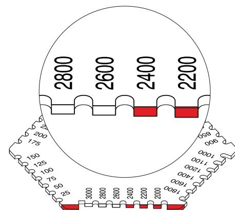
Si vous utilisez le peigne sur un tube, placez-le parallèlement à l'axe longitudinal du tube.
