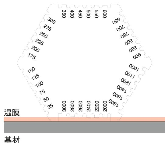
在所示的示例中，湿膜厚度在 2400µm 和 2600µm 之间。
