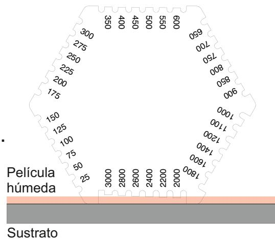
En el ejemplo mostrado, el espesor de la película húmeda se sitúa entre 2400 µm y 2600 µm.
