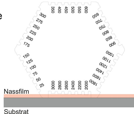
Im abgebildeten Beispiel liegt die Nassfilmdicke zwischen 2400 µm und 2600 µm.
