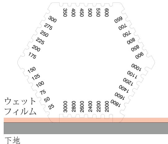
この例では、ウェットフィルムの厚さは、2400µmと2600µmの間になります。
