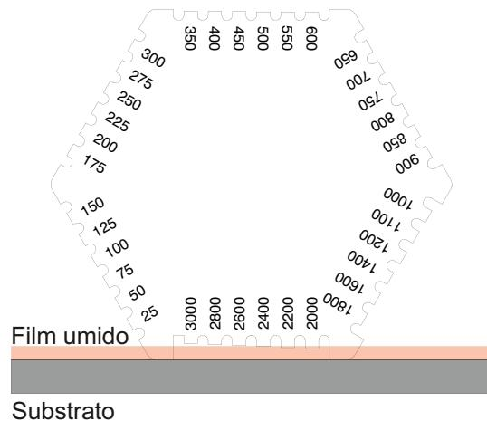
Nell'esempio riportato, lo spessore del film umido è compreso tra 2400 µm e 2600 µm.
