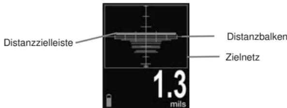
Bewegen Sie die Sondenspitze näher an das Ziel heran, während Sie auf das Messgerätedisplay achten und richten Sie den **Distanzbalken** auf die **Distanzzielleiste** aus. Die optimale Distanz zwischen der Sondenspitze und der Oberfläche des aufgetragenen Pulvers beträgt 2 cm. Stellen Sie sicher, dass der **PosiTest-PC** senkrecht zur Oberfläche gehalten wird.
