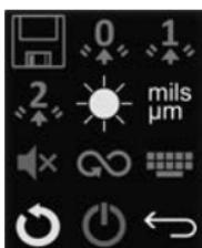
**Mode mémoire:** Active le mode Mémoire. L'instrument stocke et conserve une moyenne de 999 valeurs de mesure. Les valeurs de mesure enregistrées peuvent être téléchargées dans le logiciel PosiSoft Desktop (pg. 10). Lorsque le **mode mémoire** est activé (ON), l'option de menu suivante apparaît :
