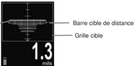
Tout en observant l'affichage de l'instrument, déplacer la sonde à proximité de la cible, tout en alignant la **palette de distance** avec la **barre cible de distance**. La distance optimale pour la mesure est de 2 cm (3/4 po.) entre la tête de la sonde et la surface de la poudre appliquée. Veiller à maintenir le **PosiTest PC** perpendiculaire à la surface.
